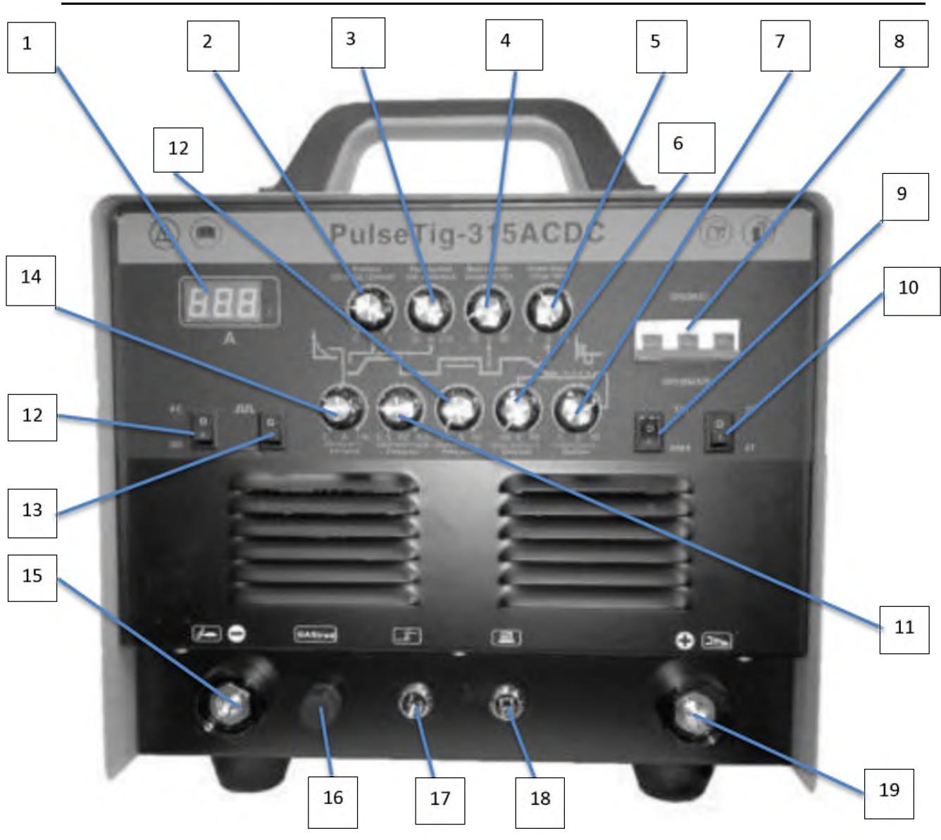
1. Многофункциональный индикатор тока, напряжения, перегрузки, защиты.
