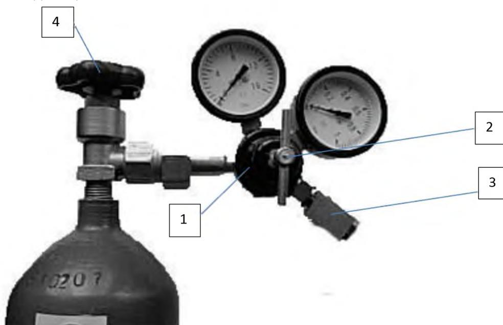
**Рисунок 2** Подключение газового шланга к типичному регулятору расхода
