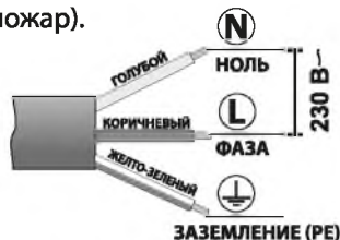
Пример подключения сетевого кабеля.
